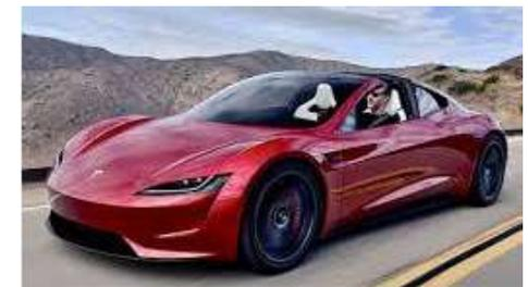
→  $V = 280$  km/h (78 m/s ;  $M 0,02$ ) Température d'arrêt : 30 °C
