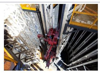
**Robotisation** des manipulations des tiges
