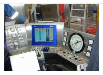
Automatisation partielle du forage par la sélection et le contrôle informatique des paramètres
