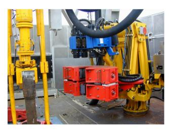
Automatisation des opérations de vissage et dévissage des tiges
